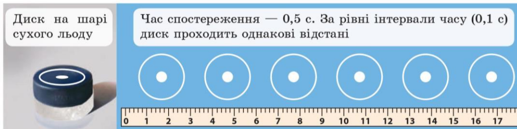
Рис. 9.2. Чим менше тертя (опір рухові тіла), тим більше горизонтальний рух тіла наближається до руху за інерцією
