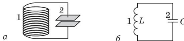
Рис. 18.1. Модель (а) та електрична схема (б) коливального контуру: 1 — котушка індуктивності; 2 — конденсатор
