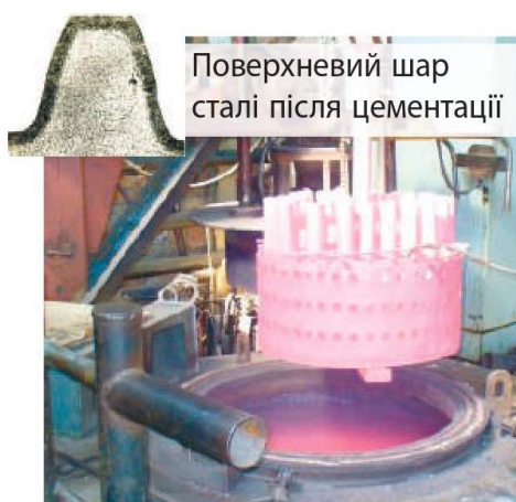
Рис. 27.4. Процес насичення поверхневого шару сталі вуглецем називають цементацією . Якщо виготовити деталь із низьковуглецевої сталі, а потім помістити її у високотемпературну суміш, яка містить вуглець, то завдяки дифузії поверхневий шар сталі збагатиться вуглецем. Отримана деталь одночасно буде твердою (ззовні — міцний чавун) і не буде руйнуватися внаслідок ударних навантажень (усередині — пружна сталь)
