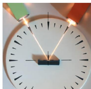
Рис. 25.4. Демонстрація оборотності світлових променів: відбитий промінь іде шляхом падаючого променя
