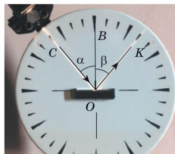
Рис. 25.2. Установлення законів відбивання світла: CO — падаючий промінь; OK — відбитий промінь; \alpha — кут падіння; \beta — кут відбивання
